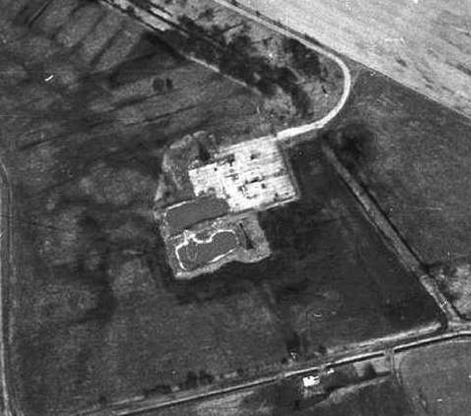
Erdgasfördersonde Pes 172 noch in Betrieb, 3 Bohrschlammgruben zu DDR-Zeiten zugeschoben Quelle: Luftbild aus 1979, LVerGeo 2018
